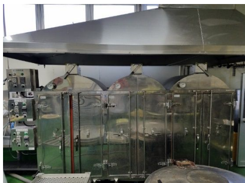
写真 3 : 大型 3 連式蒸気蒸し器
